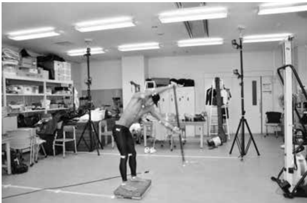
図1 モーションキャプチャシステムとフォースプレートでの実験風景
